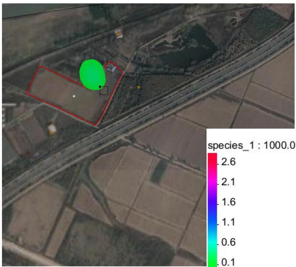
图 5.2-15 非正常状况下，氨氮渗漏对第四系潜水影响范围（1000d）
