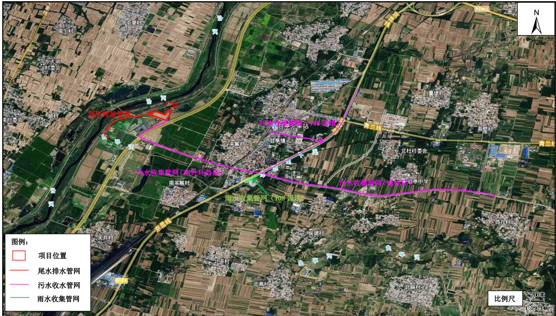
图 3.1-2 建设项目总体规划图
